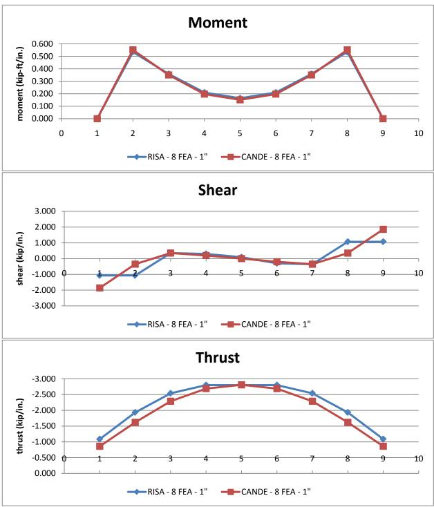
FIGURE 3.10. DEMANDS FROM SIMPLE BEAM MODEL COMPARISON.
