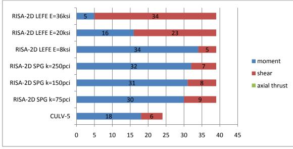
FIGURE 4.40. 1958 ERA 60KSI STEEL CONTROLLING FAILURE MODES
