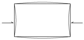
FIGURE 2.7. CULVERT DEFORMATION DUE TO LATERAL LOAD ONLY
